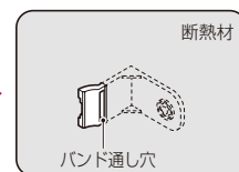
②断熱材を吹き付け、完全に硬化してから養生テープをはがします。
