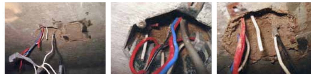
①シロアリの食害痕(損傷痕) ②シロアリ食害による漏電焼痕 ③ケーブル内にシロアリが生息している様子 ④シロアリの食害痕(損傷痕)
