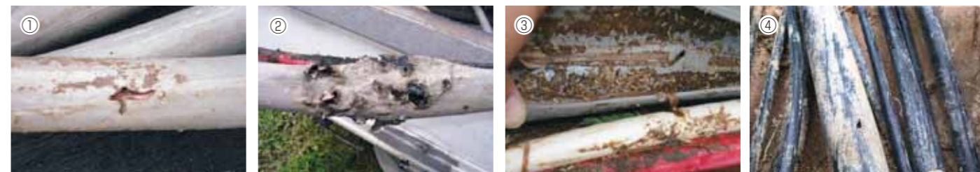
①シロアリの食害痕(損傷痕) ②シロアリ食害による漏電焼痕 ③ケーブル内にシロアリが生息している様子 ④シロアリの食害痕(損傷痕)
