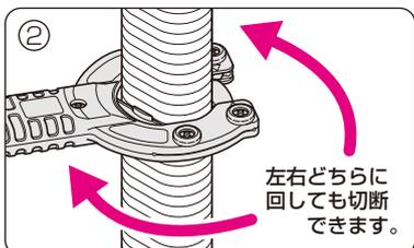
カッターを120°回転させ、切断します。どちらに回転させても切断できます。
