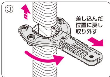
切れ端を抜き取った後、カッターを元の位置に戻し、取り外します。
