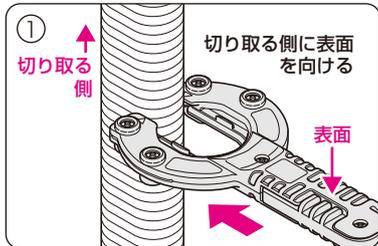
ダ円サヤ管の切り取る側に、表面を向けて差し込みます。
