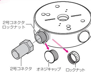
**キャップ、ロックナットを外し、コネクタを直接取り付けられ、VE管、PF管による露出配管ができます!**
