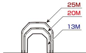
※乗越えるモールのサイズに合わせてノックを抜いて下さい。(13Mはそのまま配管できます。)
