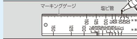
図のようにマーキングしたラインに印を書いておけば、施工後の接着忘れの確認ができます。
