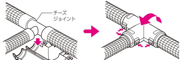
①ジョイントカバーに接続箇所(チーズジョイント)を設置します。
