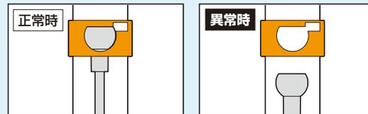
●窓枠と浮がピッタリです。 ●窓枠と浮がズれています。
