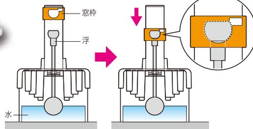
●管等に満水試験ゲージを設置し、窓枠を浮の頭部に合わせます。
