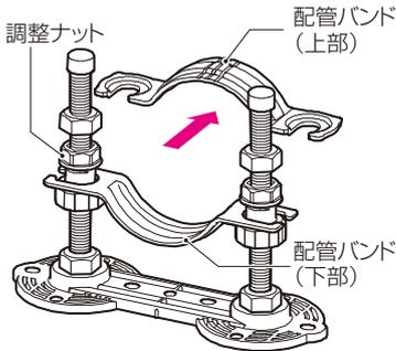
①ナットを緩めて配管バンドの上部を取り外します。
