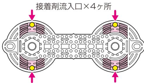
●ベース表面の接着剤流入口より接着剤を注入すると、ベース裏面の溝に沿って接着剤が流れ込むしくみになっています。(施工方法は裏面参照)
