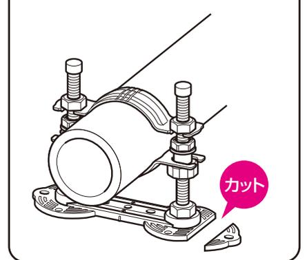
●施工完了後に、ベースプレート接着剤塗布部の接着剤流入口からカートリッジガンで接着剤を充填します。
