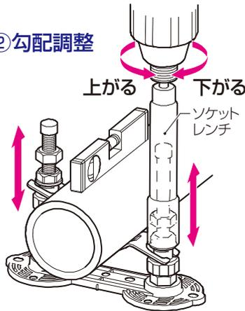
②配管を配管バンドの下部に乗せ、電動ソケットレンチで調整ナットを回転し、勾配調整を行います。
