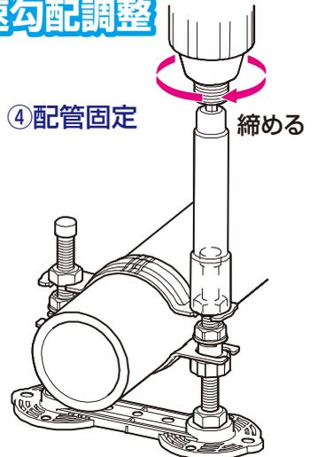
④電動ソケットレンチで上部ナットを回転し、配管バンドを固定します。
