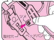
ヘッドバンドの突起をブラケット調整穴にはめ替えれば、簡単に深さ調整できます。
