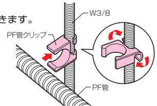
**ご注意** ボルトのねじなし部分には支持できません。また、PF管クリップの近接ではPF管を曲げないでください。
