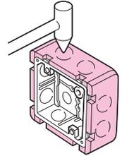
③使用するノックをシートの上からハンマー等で打ち抜き、コネクタを取り付けます。
