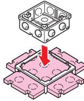
①断熱シートの離形紙を剥がし、ボックスを置き(貼り付け)ます。
