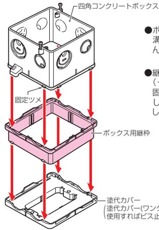
●ボックス(改良型)の固定ツメを継枠の溝(4箇所)にパチンとシッカリはめ込んでください。
