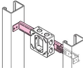
間柱への取り付け方により自在バーの取り付け面(折り返し部分)を変更してください。間柱のすく際にボックスを取り付けられます。※適合間柱間隔は組み合わせ方により異なります。
