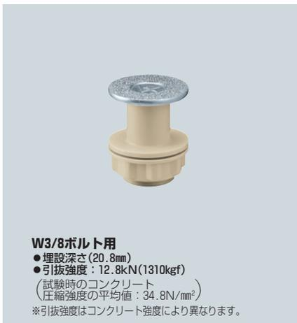
●シャンデリア等の重量物を直接樹脂コンクリートボックスに取り付ける場合等に使用します。
