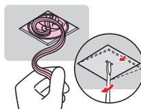
②コンクリート打設後、型枠を外し、バインド線を伸ばします。※本体に台座が残った場合は、台座の穴を探し、(一)ドライバーを差し込み、こじて外します。
