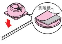
①接着面の汚れを拭き取り、うずまきコブラ2の粘着テープの剥離紙を取り、しっかりと押し貼り付け固定します。
