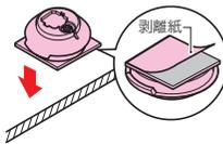
①接着面の汚れを拭き取り、うずまきコブラ2の粘着テープの剥離紙を取り、シッカリ押え貼り付け固定します。
