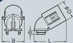
●スライドボックス側面ノックへのTLフレキ・CD単層波付管・PF単層波付管の取り付けに使用します。
