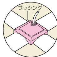
付属のブッシングを使用する場合は分岐ボックスの蓋を取り外し、ロックを抜きブッシングを差し込みます。
