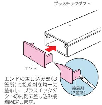
エンドの差し込み部(3箇所)に接着剤を均一に塗布し、プラスチックダクトの内側に差し込み接着固定します。
