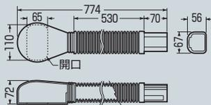
●エアコン室外機の冷媒管接続部のカバーとして使用します。
