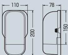
●隠ぺい配管時の冷媒管取り出し部分の化粧カバーとして使用します。
