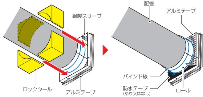
(注) 150mm厚を越える中空壁の場合は、2セットを組み合わせる等して壁厚分の鋼製スリーブを設置してください。
