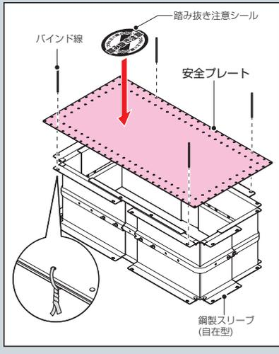
●コンクリート打設時の鋼製スリーブ(自在型)内側の汚れ防止と、開口後の落下防止用蓋として使用します。
