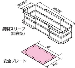
●3サイズの安全プレートの幅と長さを鋼製スリーブの開口に合わせて取り付けてください。
