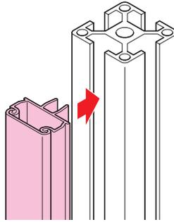
●アルミフレームの溝に差し込むだけです。
