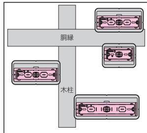
取り付ける柱面や胴縁面に合わせて中身(ボックス)の向きを入れ替えることで最適な向きに通線口を変更できます。
