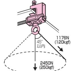
※アイボルトにミラックラダーを取り付ける場合はワイヤーが垂直に対し45°以内になるように取り付けてください。
