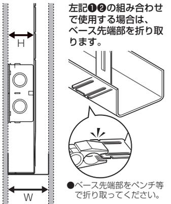
※鉄製のアウトレットボックス、塗代カバーを使用する場合は、ボックスの総深さ(H)と異なります。現物に合わせ、調整固定バー取り付け位置を決めてください。
