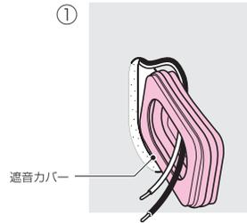
①ケーブル配線後、壁開口部に遮音カバーを押し込みながら差し込み、壁内に設置します。
