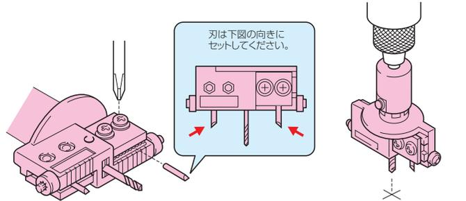
①ねじを緩め、切削径に合わせて刃の位置を付け替え(2本)ねじを締め固定します。
