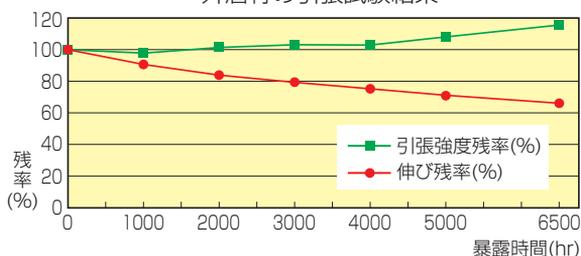
JIS A 1415 「高分子系建築材料の実験室光源による暴露試験方法」において6500hr (※約30年相当) 経過後の引張強度残率及び伸び残率は50%以上を保持しています。
