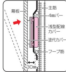
配線カバーに4mmバー等を取り付け、壁厚に合わせ4mmバー等を曲げ、壁筋等に結束固定します。
