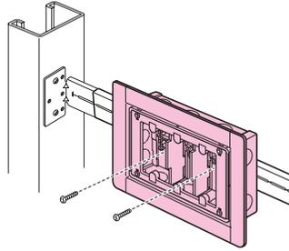
軽量間柱にボックス支持部材を取り付け、ボックス底面のスタートバー固定穴よりX線防護用スイッチボックスをねじ止め固定します。
