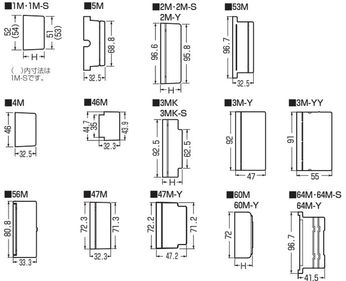
※配線器具取付枠の一部が仕切板に干渉する場合は仕切板の切り欠きを折り取ってご使用ください。(バリはナイフ等で取り除いてください)
