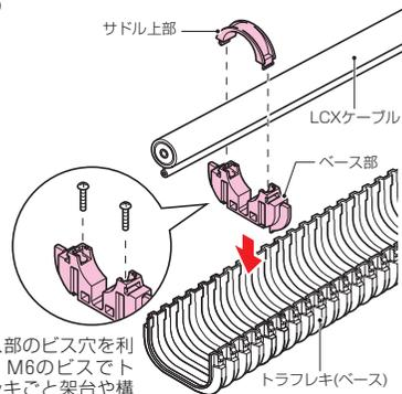
※ベース部のビス穴を利用し、M6のビスでトラフレキごと架台や構造物に固定できます。
