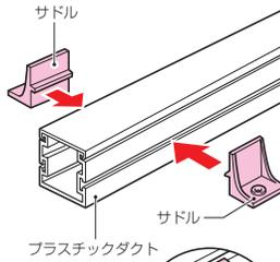
サドルをプラスチックダクトの両側面溝にはめ込み、木ねじ、アンカー等で固定します。
