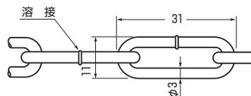
引張り強度(1.47kN(150kgf)で溶接部破断)
