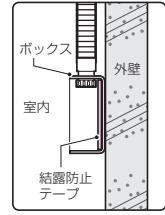
※外表面に接する面に貼り付けてください。
