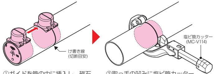
①ガイドを管の中に挿入し、磁石入りの取っ手で本体を管の切断したい部分までスライドします。
