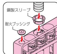
〈電線管の接続〉 鋼製スリーブを取り付け、電線管を内部ボックスのハブに差し込みます。
