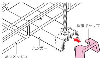
※保護キャップを付けたまま吊りボルトを取り付けられます。
