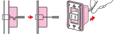
③器具のプレート穴をパッキンの凹みに合わせたらボックスにビス締め固定します。
