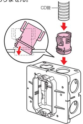
**ご注意** 埋込四角アウトレットボックス(極薄型)大形四角用、埋込スイッチボックス(極薄型)、コンクリートボックスのバックプレートには取り付けません。
