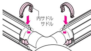
サドルを継手側にスライドさせて固定します。
