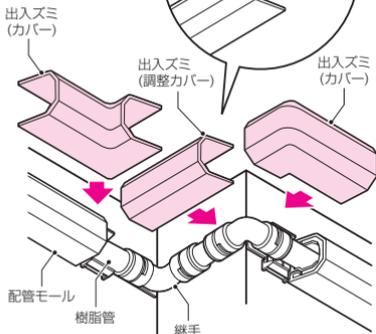
●下記の表に合わせて、出入ズミの調整カバーを切断してください。
