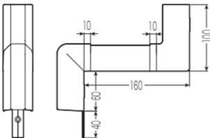
① 出入ズミと配管モールのベースを木ねじ等で固定し、調整カバーを段差巾に合わせて切断します。
