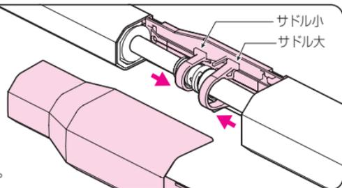
付属の小サドル、大サドルをベースにセットし、継手に当たるまでスライドさせて固定します。
