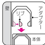
壁際に施工する場合は、アダプターの壁際側のリブをニッパー等で切り落とし、継ぎ目にはめ込んでください。
