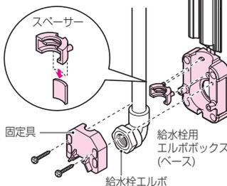
別売の給水栓ボックス用スペーサー (RMB-S2) を水栓取り出し口に接着固定し、持ち出し高さ調整をします。
