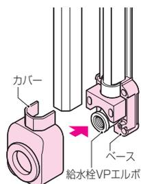
付属のプラグをエルボボックスのベースに通し、既設の配管口にねじ込むだけでベースを固定でき、従来の配管口と同じ位置に取り付けることができます。
