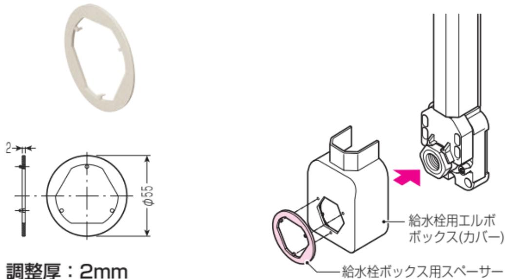
給水栓エルボボックスを使用し、混合水栓を取り付ける場合、配管するRMモールのサイズ等により適合ボックスが異なる為、スペーサーによる高さ調整が必要になります。
