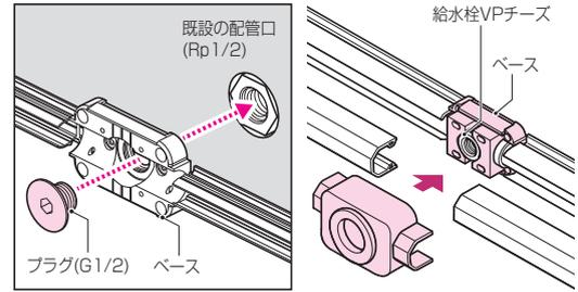
付属のプラグをチーズボックスのベースに通し、既設の配管口になじむだけでベースを固定でき、従来の配管口と同じ位置に取り付けることができます。
