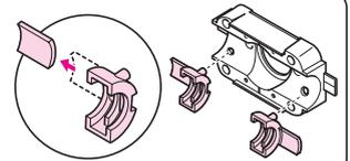
別売の給水栓ボックス用スペーサー(RMB-S2)を水栓取り出し口に接着固定し、持ち出し高さ調整をします。
