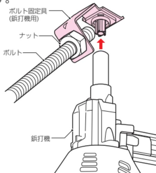
①ボルト固定具にボルトを差し込みナットで固定し、鉚打機で天井に固定します。
